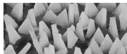
Orientación óptima del grano abrasivo VICTOGRAIN
