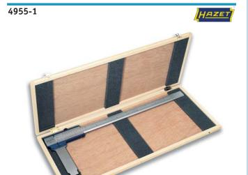
Para la verificación de desgaste en los tambores de frenos de turismos y vehículos industriales. Regla y corredera de perfil de aluminio. Boca de acero inoxidable, 150 mm de largo. Medición interior legible directamente. Con tornillo de fijación.
