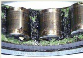
Degradación del lubricante causada por corrientes eléctricas
