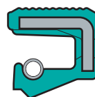
Versión BAX7 (A DIN 3760) Recubrimiento exterior rayado.
