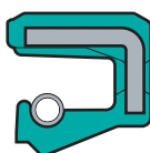
Versión BA (A DIN 3760) Recubrimiento exterior liso.
