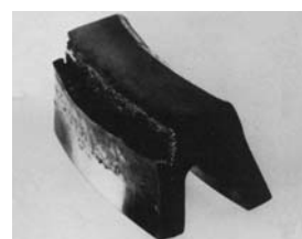
FIGURA 11. Rotura por extrusión de una junta de vástago
