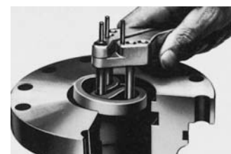
FIGURA 15. Útil de montaje 1 para juntas de vástago
