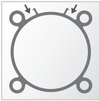
Perfil del tubo con ranuras sensores integradas original UNIVER desde 2005
