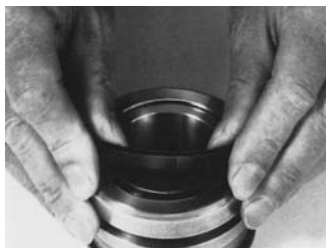
Montaje por deformación de una junta de émbolo.
