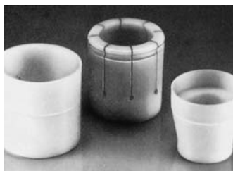
FIGURA 15. Útil de montaje 3 (para juntas de émbolo).
